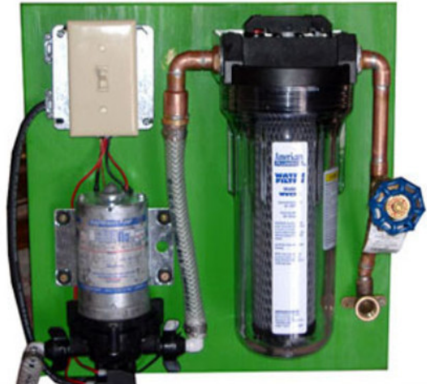
Pompe et filtre d'eau grise
